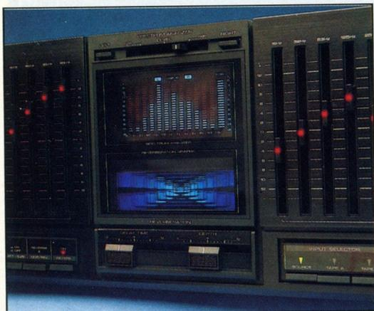
Il bel colpo d'occhio del GE-1100 acceso con, in primo piano, l'analizzatore di spettro e l'indicatore di ritardo del tempo del riverbero. Visibili anche i vari cursori di controllo ed i led rossi dei cursori di frequenza.
