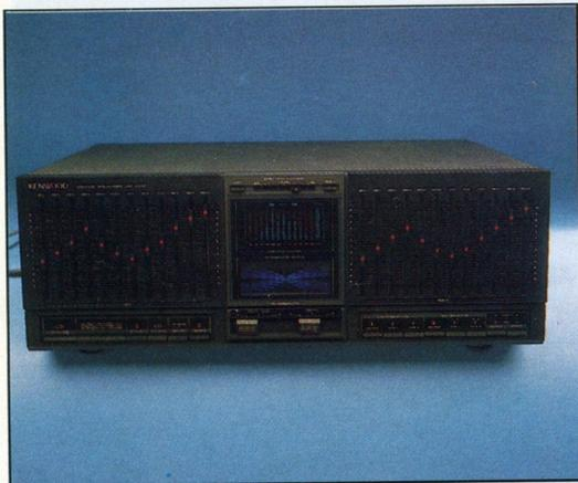
«left» e «right» servono per selezionare il canale da visualizzare. Sotto l'analizzatore di spettro si trova l'indicatore di ritardo del tempo che si illumina più o meno a seconda della maggiore o minore regolazione del comando di profondità «depth» a cui è collegato, mentre il cursore «delay time» serve per aumentare o diminuire l'effetto di riverbero regolando il segnale di ritardo del tempo.
